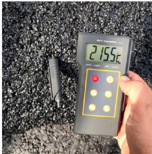
Schon seit 2008 wird Gussasphalt als Niedrigtemperatur-Asphalt mit maximal 230 °C eingebaut. Aus Nachhaltigkeitsgründen wird daran gearbeitet, diese Temperatur weiter abzusenken.
